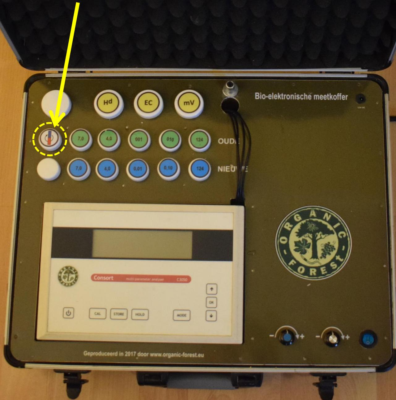
3M KCL (solution pour rereplir et conserver les electrodes de pH et redox)
